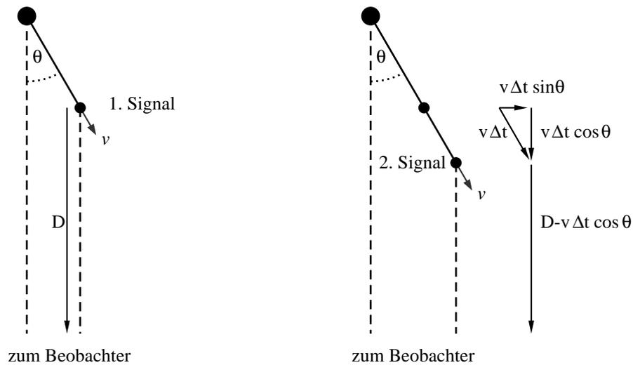
Abb. 8: Zu Aufgabe 5. Links: Aussenden des ersten Lichtsignals zur Zeit  $t_1$  in einer Entfernung  $D$  vom Beobachter. Rechts: Aussenden des zweiten Lichtsignals zur Zeit  $t_1 + \Delta t$ : In der Zwischenzeit hat sich der Knoten weiterbewegt.
