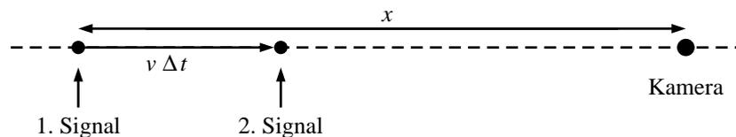
Abb. 3: Ein Objekt nähert sich der Kamera mit Geschwindigkeit  $v$ . Ein Objektpunkt sendet im Abstand  $x$  von der Kamera ein erstes Signal (links) und eine Zeit  $\Delta t$  später ein zweites (rechts).
