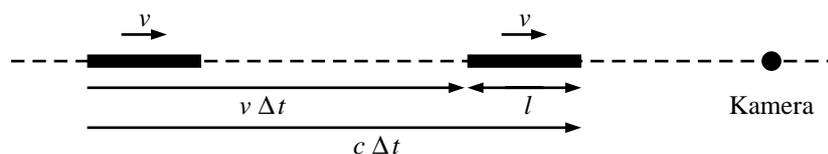
Abb. 2: Ein Stab nähert sich mit der Geschwindigkeit  $v$  der Kamera, die ihn photographiert. Ein Lichtstrahl, der zum Zeitpunkt  $t_1$  (links) vom Stabende emittiert wird, erreicht die Kamera gleichzeitig mit einem Lichtstrahl, der zum Zeitpunkt  $t_1 + \Delta t$  (rechts) von der Stabspitze startet.
